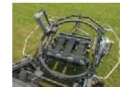
L'anello di fasciatura è quindi azionato e guidato da rulli in gomma. Due ulteriori rulli idraulici assicurano che la guida e il tensionamento dell'anello rimanga costante.
