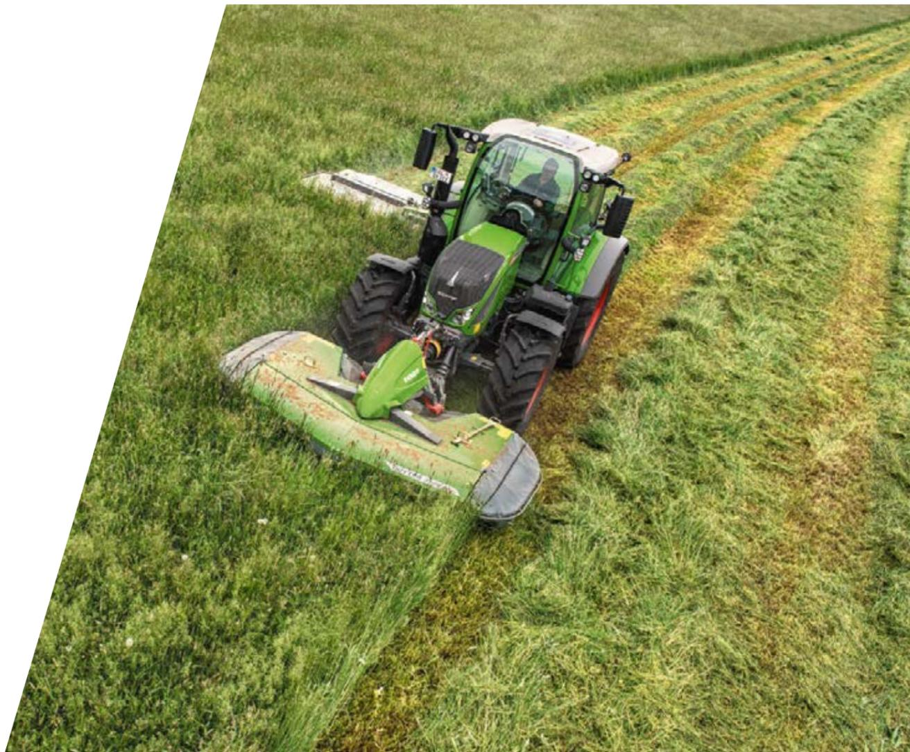
Con la possibilità di oscillare di +/- 5° il modello Fendt FPV può adattarsi al terreno, per catturare fino all'ultimo stelo d'erba.
