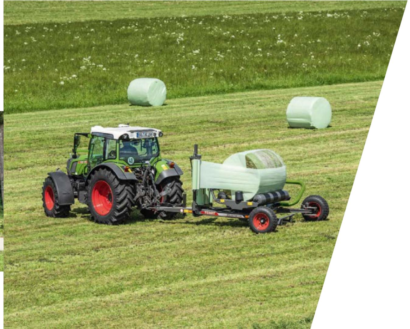
Il numero degli strati di pellicola può essere regolato facilmente a seconda del tipo di foraggio e del tempo di stoccaggio necessario. Si può impostare il numero di giri utilizzando il pannello di comando al fine di ottenere il numero corretto di strati di pellicola.
