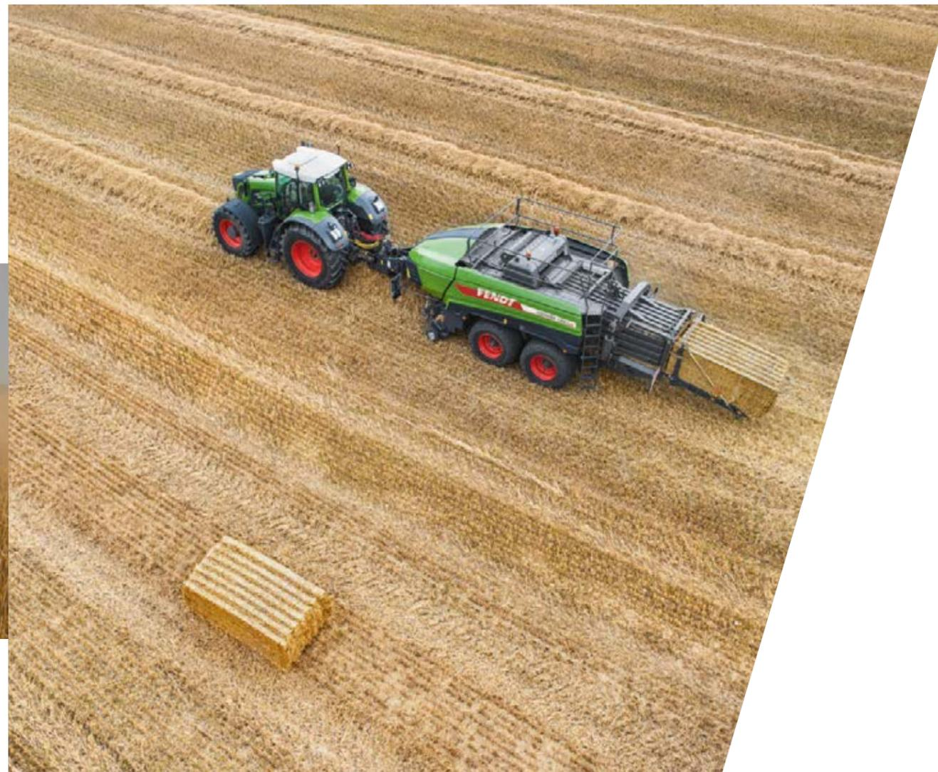
Il cilindro di densità più grande del 55% (178 mm totali di diametro) rispetto alla rotopressa per balle quadrate Fendt XD genera una potenza sufficiente per ottenere il massimo del peso della balla.
