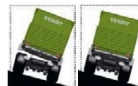
Con il controllo automatico del livellamento FSC invece il veicolo è sempre parallelo al pendio. Il veicolo si adatta sempre all'altezza ottimale del telaio in funzione del carico.
