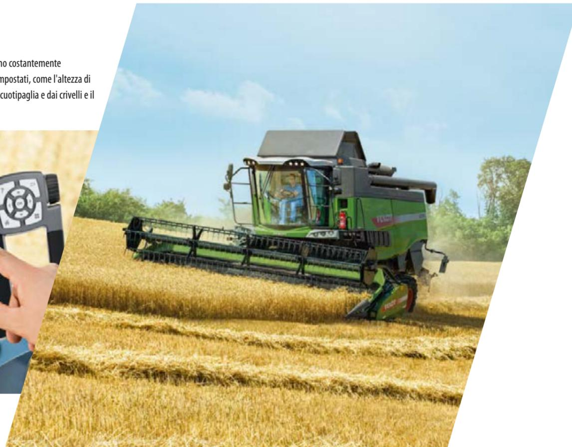
Le nostre mietitrebbie Fendt Serie C e Fendt Serie L sono disponibili nella versione ParaLevel. Il sistema si basa su un parallelogramma e compensa i dislivelli fino al 20%.
