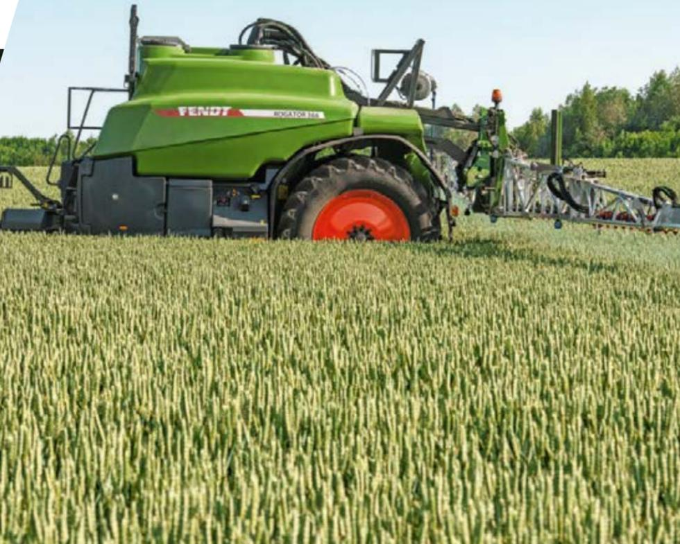
La portata massima della pompa di 785 l/min rende la distribuzione di fertilizzante liquido un gioco da ragazzi.
