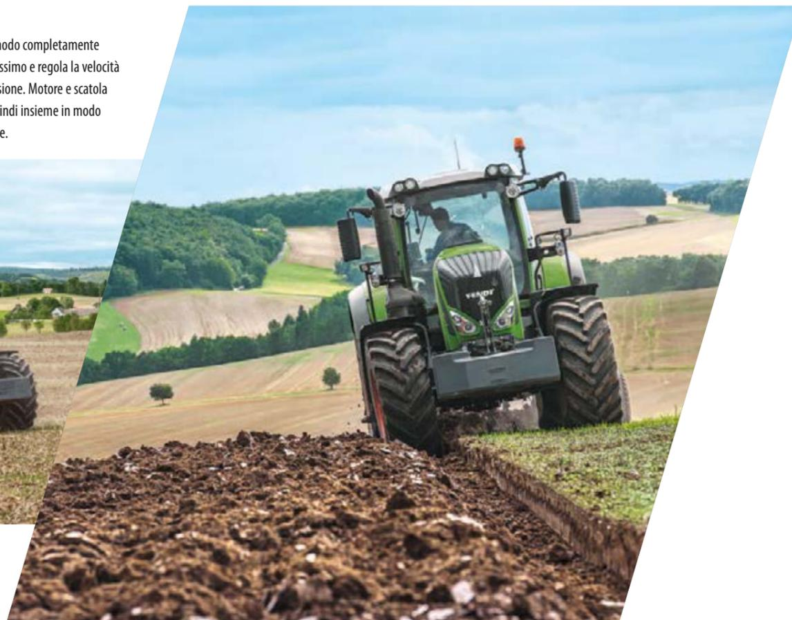
La sospensione dell'assale anteriore di Fendt 800 e 900 Vario non offre solo un grande comfort su strada ai 60 Km/h, se lo si regola appositamente per il lavoro nel campo, non perde il contatto con il suolo migliorando perciò la trazione.
