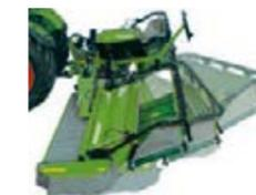
L'esclusiva protezione antiurto brevettata SafetySwing può fare oscillare la falciatrice combinata verso l'alto e verso il lato posteriore, se necessario, fino a 1,5 m.
