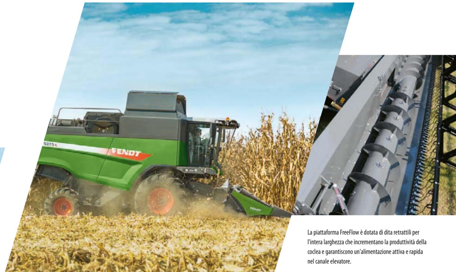
La piattaforma FreeFlow è dotata di dita retrattili per l'intera larghezza che incrementano la produttività della coclea e garantiscono un'alimentazione attiva e rapida nel canale elevatore.
