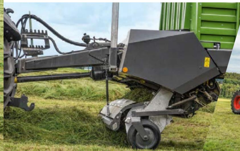
Il girante del Fendt Tigo entusiasma per la sua forza e la sua enorme capacità produttiva. Fendt Tigo si distingue per la sua qualità di taglio resa possibile dai denti dei giranti di 25 mm di larghezza, dotati di superfici di contatto in Hardox.
