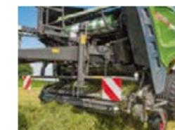
L'EasyLoadSystem permette di applicare rotoli di rete nel minor tempo possibile. Il sistema di legatura VarioNet funziona con tutte le larghezze delle reti standard da 1,18 a 1,35 m.
