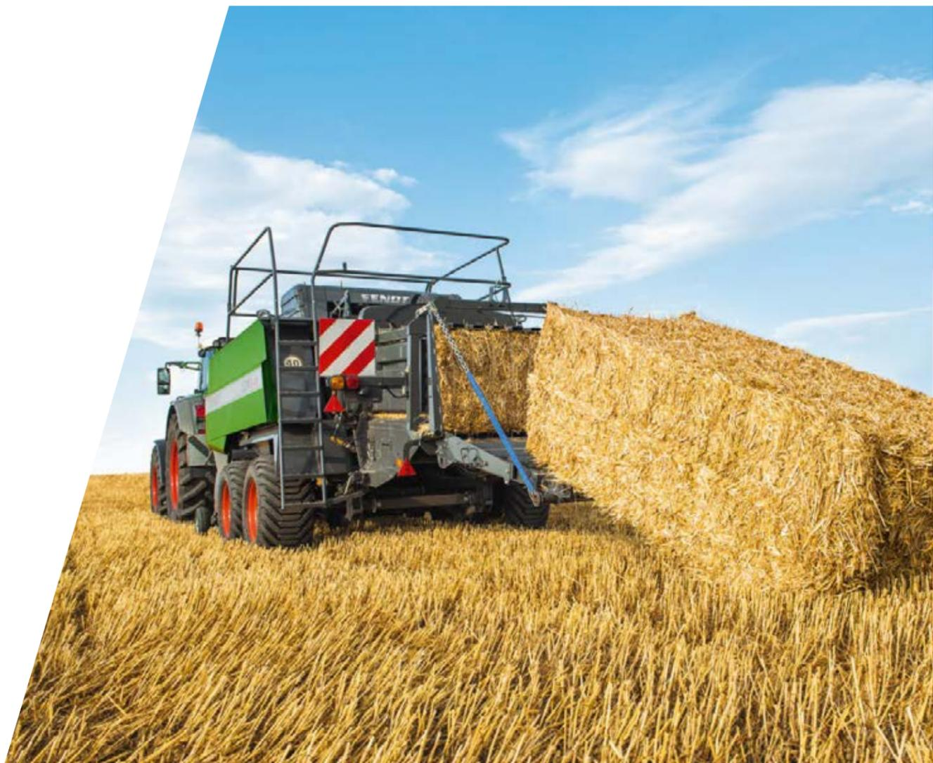
Le pareti della camera di pressatura vengono controllate automaticamente dai cilindri idraulici a doppio effetto sul canale di pressatura.
