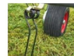
I denti "Super C" di 9,5 mm sono in acciaio ad elevata resistenza e si caratterizzano per la lunga durata e i risultati eccezionali.
