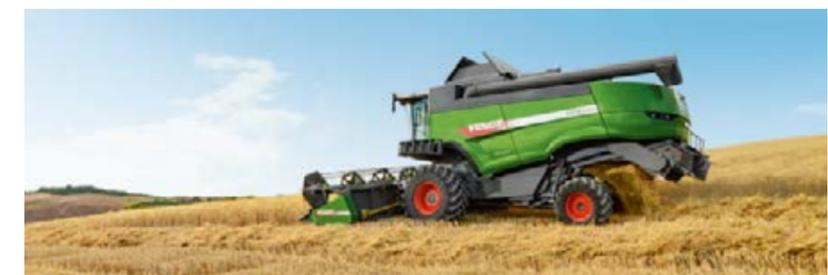
Per ridurre le usure causate dalla raccolta su riso, impieghiamo materiali specifici molto resistenti, in particolare in tutti i componenti della macchina a contatto con il passaggio del prodotto, come coclee ed elevatori.
