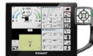
La pagina delle informazioni, in alto a sinistra, mostra i giri del motore e la velocità di marcia. Accanto si trovano i display per carburante, AdBlue, olio e temperatura del motore. Questo grafico indica lo stato di riempimento del serbatoio granella e la posizione della coclea di scarico.
