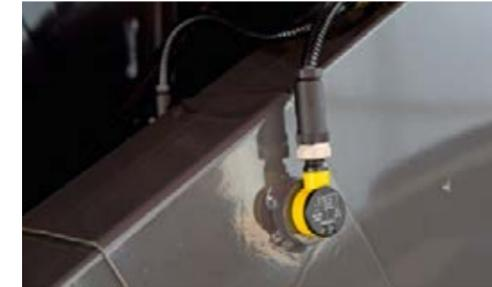
È possibile impiegare la videocamera del recupero per tracciare in qualsiasi momento la qualità di trebbiatura e reagire in modo semplice e veloce alle mutevoli condizioni di raccolta.
