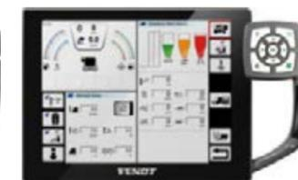
I valori correnti e preimpostati, come altezza di taglio, scuotipaglia, perdite di granella dai crivelli e volumi di recupero sono visualizzati nel menù principale. Di seguito sono riportate le impostazioni per la velocità del battitore, la distanza del controbattitore, la velocità del ventilatore e l'apertura dei crivelli. Regolabili velocemente con i tasti di selezione rapida sullo schermo.
