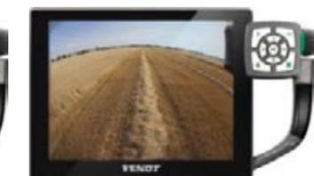
Nella parte inferiore della finestra del terminale possono essere visualizzate contemporaneamente fino a due telecamere. Si può scegliere se visualizzare la vista della videocamera in continuo oppure solo in alcuni casi, come ad esempio durante la retromarcia. L'immagine può essere ingrandita tramite comando a sfioramento, fino a riempire l'intero schermo.
