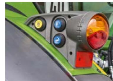
Comando esterno per sollevatore e presa di forza posteriore. Il montaggio dell'attrezzatura posteriore diventa ancora più comodo e l'operatore evita di salire e scendere dal trattore in continuazione, ad es. per caricare la botte di liquame.
