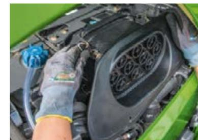
La migliore accessibilità, come mostrato in figura nel caso della sostituzione del filtro aria, è una caratteristica di tutti i trattori Fendt Vario e riduce i tempi per gli interventi di manutenzione.
