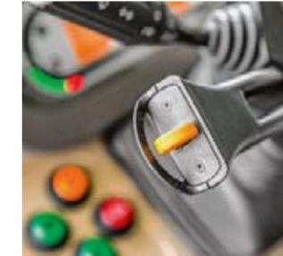
Tutte le connessioni posteriori sono identificate tramite colori e disposte con chiarezza. I cappucci delle valvole a chiusura automatica impediscono l'ingresso di sporcizia.
