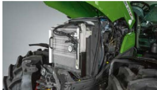
Il vano motore si caratterizza per essere accessibile molto facilmente per ispezioni e manutenzioni, anche con attrezzi montati sul caricatore frontale. Il cofano ha due aperture separate per renderne più agevole l'apertura.
