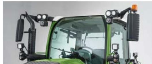
illuminazione incrociata Fendt unica nel suo genere: i fari di lavoro esterni evitano efficacemente la formazione di ombre. Il segreto è racchiuso nell'illuminazione incrociata Fendt unica nel suo genere. In questo modo si riesce ad evitare il riflesso del vano motore e la proiezione di ombre, regalando un campo illuminato particolarmente ampio indipendentemente dalla lavorazione che state eseguendo.
