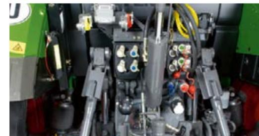
Gli accoppiamenti idraulici sul lato posteriore sono allineati con precisione e si contraddistinguono in base al colore. I tappi antipolvere si chiudono da soli. Per facilitare l'accoppiamento, i collegamenti sono sfalsati e possono essere disaccoppiati sotto pressione.
