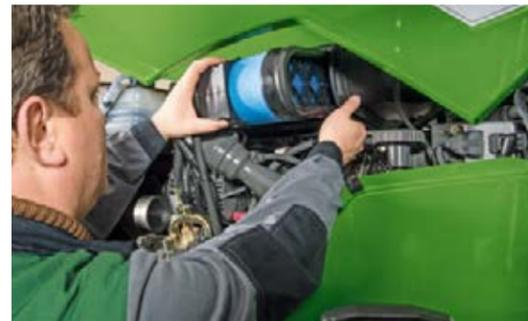
Il filtro dell'aria ad alte prestazioni è ottimale in termini di apporto di aria e di pulizia, ed è anche facile da sostituire.
