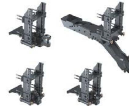
Il 300 Vario offre la possibilità di scegliere tra 4 sistemi di attacco inferiore: barra di traino oscillante, gancio di traino, Piton fix e accoppiamento a sfera.
