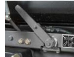
Fissaggio dei bracci inferiori: i bracci inferiori possono essere fissati con la valvola di intercettazione sul sollevatore posteriore. In questo modo è possibile evitare un utilizzo scorretto e danni agli attrezzi collegati.
