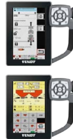
**Bloccaggio automatico assale sterzante:** il bloccaggio automatico a richiesta interviene sull'assale sterzante per il rimorchio a partire da una determinata velocità selezionabile. In rettilineo l'assale sterzante rigido assicura una marcia stabile. Al di fuori dei valori di velocità selezionati e in retromarcia l'operatore non deve bloccare manualmente l'assale sterzante.
