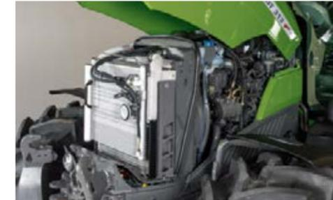
Massima accessibilità per la manutenzione: la presa d'aria diretta e il pratico accesso al condensatore ribaltabile e ai refrigeranti rendono la manutenzione estremamente agevole. Il radiatore a fondo piano assicura una bassa sensibilità allo sporco.
