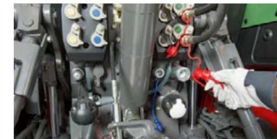
Power Beyond è disponibile sul lato posteriore per il funzionamento di macchine idrauliche heavy-duty. L'intera potenza idraulica è disponibile direttamente senza alcuna strozzatura o resistenza inutile. Il ritorno senza pressione con un'ampia sezione trasversale diminuisce la resistenza.
