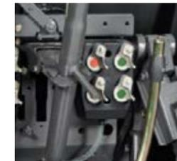
Indicazioni chiare e ben accessibili: i distributori idraulici possono essere accoppiati sotto pressione tramite gli accoppiamenti DUDK e UDK, semplificando al massimo l'innesto e il disinnesto dell'attrezzo. Ulteriore vantaggio: i distributori a chiusura automatica garantiscono una protezione totale da polvere e infiltrazioni.
