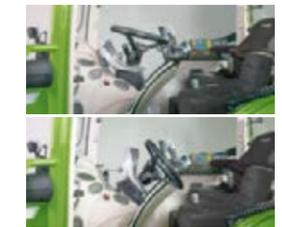
Volante e quadro strumenti perfettamente regolabili: Per una posizione di seduta ottimale, il volante e il quadro strumenti devono essere alla giusta altezza e al corretto angolo di inclinazione.
