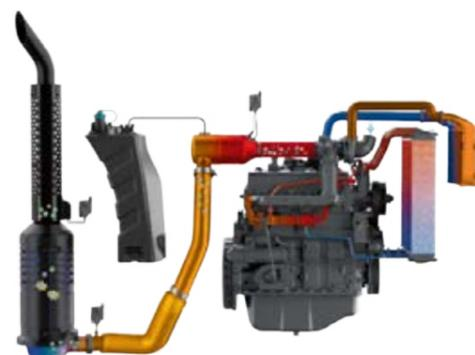
Con la tecnologia SCR, i gas di scarico sono sottoposti a un post-trattamento con AdBlue, una soluzione di urea al 32,5%, e gli ossidi di azoto NO<sub>x</sub> vengono trasformati in azoto atossico e acqua.
