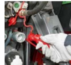
□ Presa Power beyond: linea di pressione e di pilotaggio diretta per trasmissione di potenza idraulica dalla pompa di comando direttamente all'attrezzo di lavoro.
