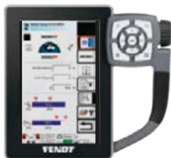
Gli schermi forniscono una panoramica perfetta della leva a croce, del sistema di pesatura dei singoli pesi, del peso complessivo e della regolazione dell'altezza di sollevamento e dell'angolo di inclinazione.
