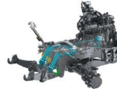
Il sollevatore anteriore è completamente integrato ed è ben saldo al veicolo, preservando così l'elevata manovrabilità degli attrezzi collegati. I bracci inferiori hanno un aggancio inferiore particolarmente efficace e possono essere ripiegati per il parcheggio. Le guarnizioni a soffietto proteggono i cilindri di sollevamento dai sassi. Lo smorzatore delle oscillazioni montato di serie impedisce il beccheggio e garantisce sicurezza e comfort di marcia.
