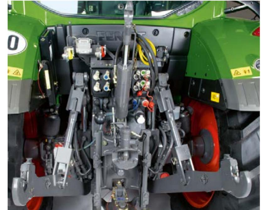
**Tra i punti di collegamento posteriori vi sono:** presa per segnali, terzo punto idraulico, bracci inferiori con ganci, distributori, ritorno libero per l'olio idraulico, freno ad aria, linea di pressione e condotto di pilotaggio dell'attacco Power Beyond, freni rimorchio idraulico, presa a 7 pin, gancio di traino, prese di forza posteriori 540, 540 E e 1000 giri/min, varie configurazioni del gancio di traino, barra di traino rigida e molto altro.
