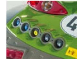
Il sollevatore posteriore, la presa di forza e un distributore possono essere controllati da entrambi i parafanghi posteriori.
