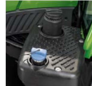
Il pre-filtro carburante con valvola termostatica permette al trattore di avviarsi in modo affidabile, anche a temperature esterne molto basse. Il radiatore e il filtro sono disposti in modo da facilitare la manutenzione.
