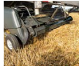
Un largo pick-up con rullo compressore e una piastra deflettrice larga garantiscono il flusso regolare di prodotto.
