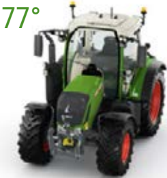
Parabrezza panoramico con visuale di 77 gradi per la massima visibilità verso l'alto e sui passaruota.
