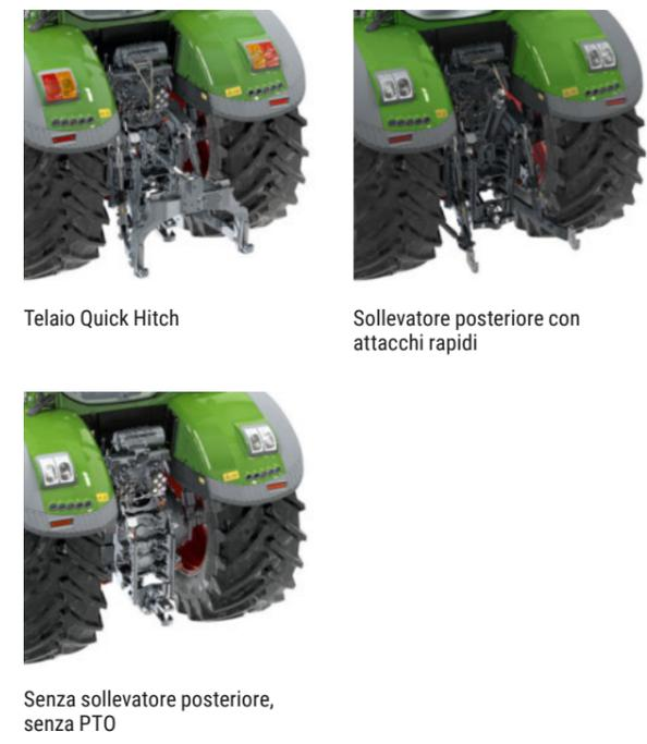
Telaio Quick Hitch      Sollevatore posteriore con attacchi rapidi
