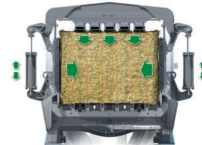
La camera di precompressione viene continuamente riempita dall'infaldatore. Solo quando è piena, il sensore delle pareti sul fondo della camera di pre-compressione innesca il rastrello. I denti dell'infaldatore vengono ritirati e viene creato lo spazio che conduce al canale di pressatura principale.
