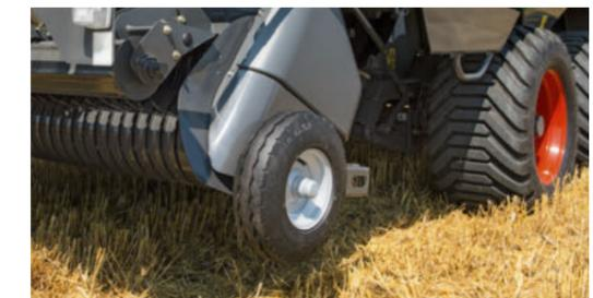
Le ruote di regolazione evitano che il pickup venga abbassato troppo e assicurano una raccolta pulita. È possibile rimuoverle per effettuare il trasporto.
