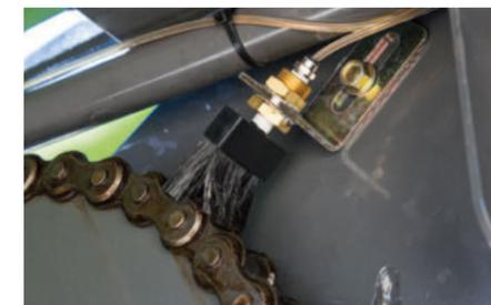
La lubrificazione automatica di tutte le più importanti catene di trasmissione rappresenta una novità. È possibile impostare opportunamente gli intervalli di lubrificazione mediante il terminale.
