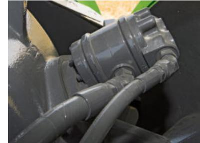
Le pareti della camera di pressatura vengono controllate automaticamente dai pistoni idraulici a doppio effetto sul canale di pressatura.
