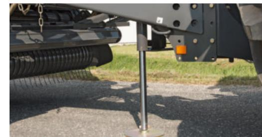
La staffa di stazione idraulica facilita l'operazione di aggancio e sgancio del trattore.
