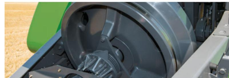
Il volano da 545 kg consente un funzionamento uniforme e regolare, garantendo un'elevata trasmissione di potenza.
