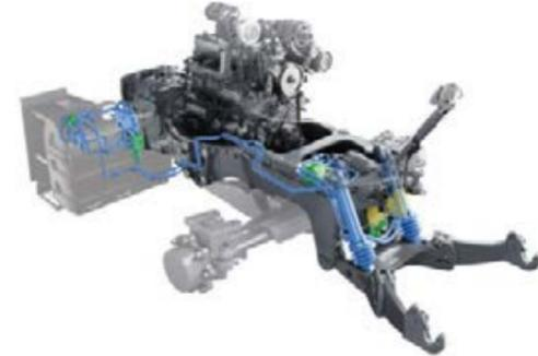
Il sollevatore anteriore è completamente integrato ed è ben saldo al veicolo, preservando così l'elevata manovrabilità degli attrezzi collegati. I bracci inferiori hanno un aggancio inferiore particolarmente efficace e possono essere ripiegati per il parcheggio. Le guarnizioni a soffietto proteggono i cilindri di sollevamento dai sassi. Lo smorzatore delle oscillazioni montato di serie impedisce il beccheggio e garantisce sicurezza e comfort di marcia.
