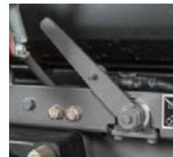
Prevenzione di utilizzo improprio e danneggiamento degli attrezzi: messa in sicurezza del braccio inferiore con la valvola di intercettazione.
