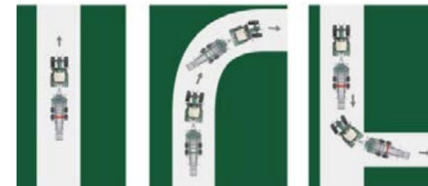
**Bloccaggio automatico assale sterzante:** Questo sistema di assistenza sblocca l'assale sterzante automatico del rimorchio a una velocità predefinita. In rettilineo l'assale sterzante rigido assicura una marcia stabile. Al di fuori dei valori di velocità selezionati o in retromarcia l'operatore non deve bloccare manualmente l'assale sterzante.
