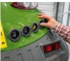
Il sollevatore posteriore, la presa di forza e un distributore possono essere controllati da entrambi i parafanghi posteriori.
