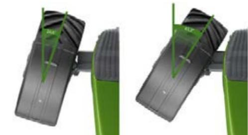
In capezzagna o durante operazioni con il caricatore frontale, potrete beneficiare della sterzata VarioActive\* che con un solo giro del volante vi permetterà di raggiungere già il massimo angolo di sterzata. Fino a 8 km/h il sistema di sterzo sovrapposto è illimitato, da 8 a 18 km/h l'effetto di sovrapposizione è lineare.
