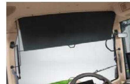
Una caratteristica particolare del Fendt 300 Vario è la maniglia verticale nel finestrino posteriore, che consente di aprire e chiudere il finestrino stando comodamente seduti.
