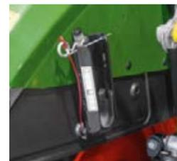
Supporto porta sfere: supporto per riporre in sicurezza le sfere per gli attrezzi completamente integrato sul parafango posteriore.
