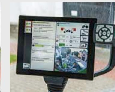
L'immagine della videocamera può anche essere visualizzata in quattro sezioni. In tal modo si hanno tutte le informazioni sotto controllo, a seconda delle operazioni in corso.
