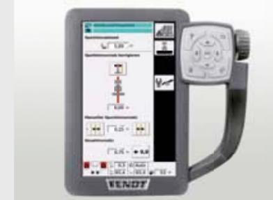
VarioGuide light è il sistema di guida parallela più economico con una precisione di +/- 20 cm. Si comanda come gli altri sistemi utilizzando il terminale Vario da 7".
