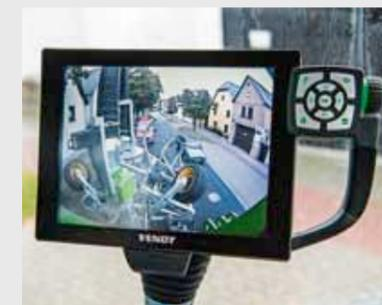
Una o entrambe le videocamere possono essere impostate per passare automaticamente alla visualizzazione a tutto schermo in retromarcia.
