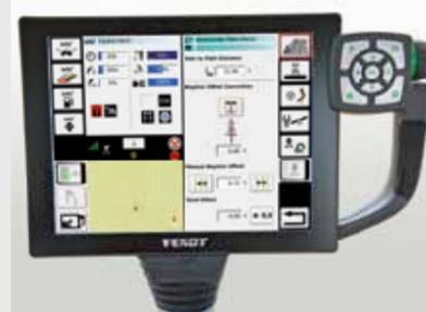
Nei trattori, il sistema VarioGuide offre ulteriori funzioni in capezzagna. In combinazione con Variotronic<sup>TM</sup> automatic, è possibile attivare sequenze automatiche della gestione capezzagna.
