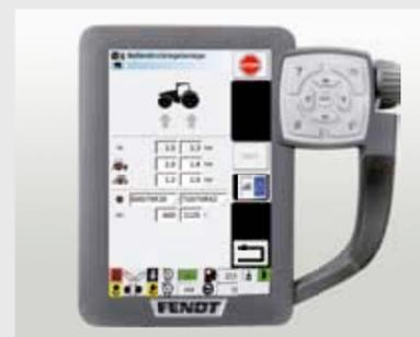
Il comando del sistema di regolazione della pressione di gonfiaggio dei pneumatici è integrato nella struttura generale della macchina. Dal terminale Vario, la pressione dei pneumatici può essere controllata semplicemente premendo un tasto.
