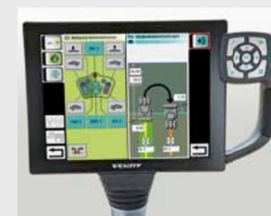
La gestione per capezzagna Variotronic™ automatic consente di attivare automaticamente le sequenze in capezzagna. Nel terminale è possibile impostare le sequenze da utilizzare per eseguire e terminare la manovra di svolta. Un grafico intuitivo facilita il processo.
