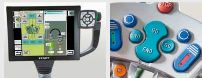
Se necessario, le funzioni di controllo attrezzi e gestione capezzagna possono essere assegnate alla leva multifunzione. Ad ogni operatore è garantita una perfetta ergonomia di comando dell'operazione in corso. In combinazione con il sistema di guida parallela VarioGuide, Variotronic<sup>®</sup> automatic consente l'attivazione automatica di sequenze in capezzagna.
