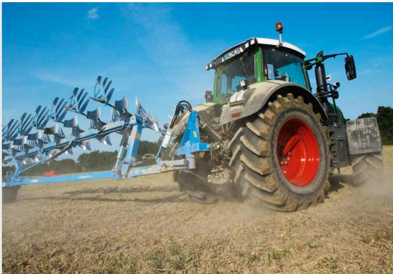
Con la gestione capezzagna Variotronic™ l'operatore può creare sequenze di operazioni sia in marcia che a veicolo fermo e salvarle. Le impostazioni per il comando di cambio e motore, dei distributori e del sollevatore anteriore e posteriore, della presa di forza anteriore e posteriore nonché della guida parallela insieme alle rispettive singole funzioni vengono effettuate tramite il sistema di gestione capezzagna e possono essere richiamate facilmente.
