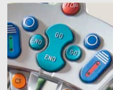
Quattro sequenze della gestione capezzagna possono essere attivate in modo pratico con il joystick – due in fase di ingresso in carreggiata e due in uscita.
