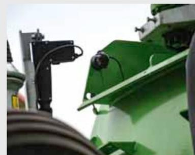
L'uso di telecamere sulle macchine aumenta significativamente il comfort e la sicurezza. Soprattutto sulle macchine più grandi è possibile vedere meglio ciò che accade intorno. Il grande terminale Vario da 10,4" o 10.4-B consente di collegare fino a due telecamere.
