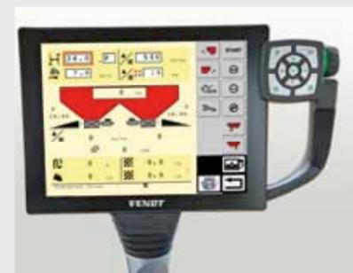
Il sistema di gestione attrezzi Variotronic ISOBUS si integra perfettamente nel terminale Vario 7" (non nelle versioni 500 Vario e 700 Vario Power) e nel terminale Vario 10.4"/10-B. L'attrezzo viene controllato con il terminale e il joystick, non è richiesto un terminale supplementare. In modalità a schermo intero, il terminale Vario diventa un vero e proprio terminale ISOBUS.
