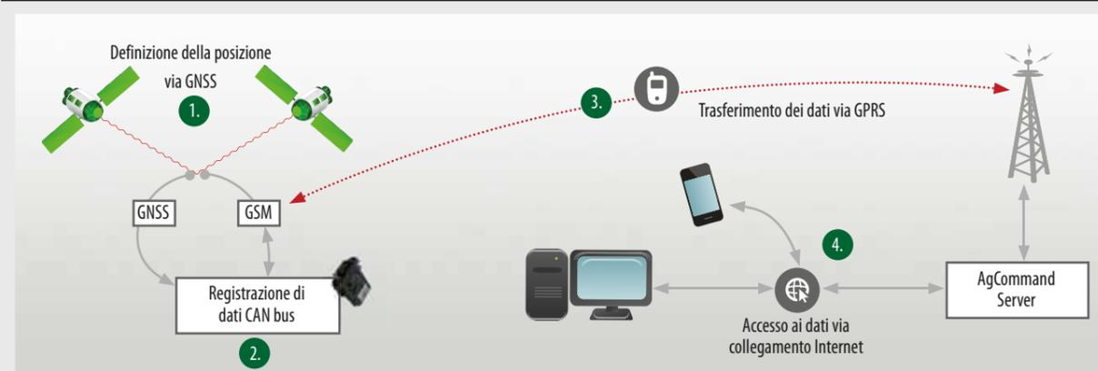
AgCommand garantisce un collegamento costante con le macchine e l'operatore. Il suo ingegnoso principio di funzionamento consente di:
