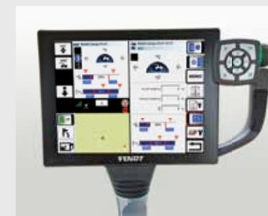
Il caricatore frontale intelligente CargoProfi viene comandato con la leva a croce di destra e con la leva per l'inversione di marcia sul volante. I limiti del raggio di lavoro del braccio e dell'attrezzo possono anche essere impostati dal terminale.
