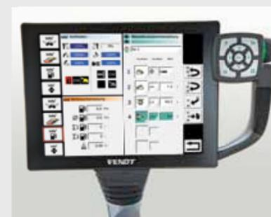
Per ottimizzare la sequenza delle operazioni, queste possono essere programmate a veicolo fermo senza fretta. Se necessario, l'operatore può regolare e ottimizzare la sequenza operativa mentre lavora.
