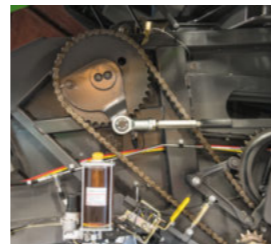
■ Tutti gli annodatori e le catene di trasmissione importanti vengono lubrificati automaticamente e gli intervalli di lubrificazione possono essere impostati semplicemente ricorrendo all'utilizzo del terminale.
