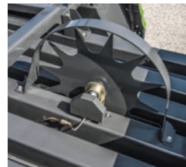
■ Regolazione semplice con controllo elettronico della lunghezza delle balle
