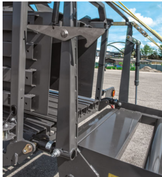
■ Le celle di carico tra la camera di pressatura e lo scivolo di scarico misurano il peso esatto della palla e inviano i dati simultaneamente al vostro terminale. Il sistema è protetto grazie al set di cablaggio integrato, rendendo pertanto difficile la lacerazione dei cavi.
