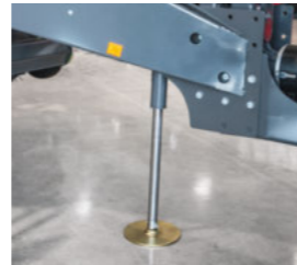
□ La staffa di stazionamento idraulico opzionale consente di eseguire agganci e sganci dal trattore in modo semplice e rapido.
