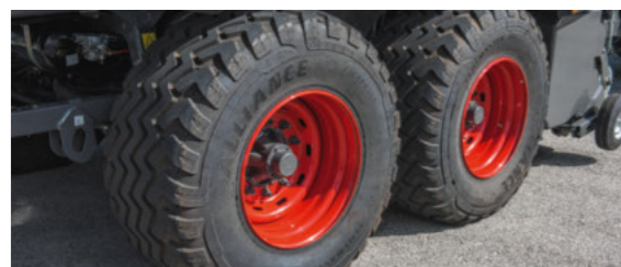
■ Grazie al nuovo telaio, Fendt Squadra 1290 UD è disponibile in varie larghezze esterne con diversi pneumatici: pneumatici 620/50R22.5 o 620/55R26.5 per una larghezza esterna inferiore ai tre metri e una dimensione massima degli pneumatici di 710/50R26.5 per una larghezza esterna di 3,20 m.
