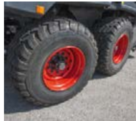
■ L'assale tandem a sterzata posteriore garantisce un'ampia area di contatto e un elevato grado di manovrabilità.
