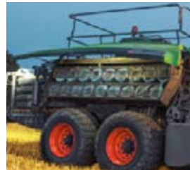
■ I fari di lavoro a LED consentono di eseguire il riempimento dello spago in modo semplice e rapido persino al buio.
