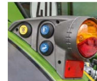
Comandi esterni per il sollevatore e innesto della presa di forza posteriore con regime motore aumentato. Il montaggio dell'attrezzatura posteriore diventa ancora più comodo e l'operatore evita di salire e scendere dal trattore in continuazione, ad es. per caricare la botte di liquame.
