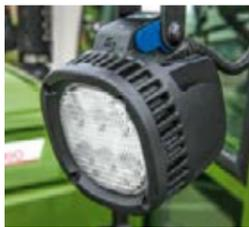
I fari di lavoro a LED opzionali possono essere montati davanti e dietro per garantire un'illuminazione ottimale a 360 gradi nei lavori notturni con il Fendt 200 Vario.
