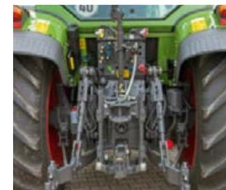
Freno pneumatico a 2 linee, 4 distributori e Power Beyond. È possibile accedere a tutte le connessioni con codifica colori in modo sicuro e comodo nonostante la struttura compatta della macchina.
