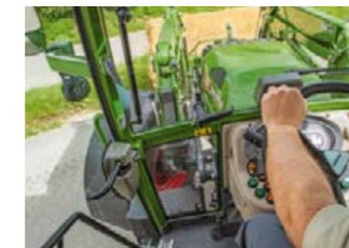
Grazie alla generosa vetratura e allo stretto piantone dello sterzo le attrezzature sono sempre perfettamente sotto controllo. Il finestrino sul tetto di serie offre un'eccellente visibilità quando si lavora con il caricatore frontale.
