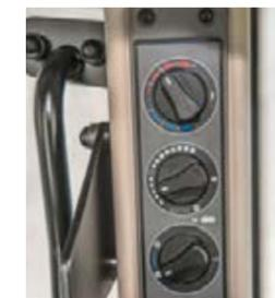
Semplicità di controllo del climatizzatore, con riscaldamento a pavimento a richiesta per l'inverno.
