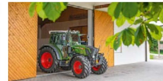
Con la sua altezza minima di 2.480 mm e pneumatici 480/70R30, il compatto Fendt 200 Vario è adatto all'impiego in strutture basse.
