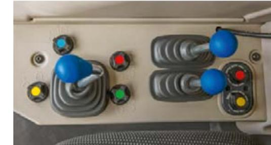
Comodo sollevatore posteriore a comando idraulico con compensatore attivo delle oscillazioni.
