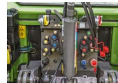
Tutte le connessioni posteriori sono identificate in modo permanente e disposte con chiarezza. I cappucci delle valvole a chiusura automatica impediscono l'ingresso di sporcizia.
