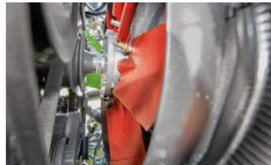
Ventola reversibile con pale regolabili per condizioni particolarmente polverose. Vantaggio: pulizia delle griglie di raffreddamento senza che sia necessario uscire della cabina, per prestazioni ed efficienza maggiori.
