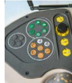
Doppia trazione e bloccaggio differenziali: lo sterzo automatico e il sistema in funzione della velocità per la doppia trazione e il bloccaggio differenziali multidisco posteriore sono di grande utilità.
