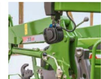
Una leva sul telaio di montaggio sblocca agevolmente l'attrezzo terminale con un solo movimento. Durante il montaggio, l'attrezzo si blocca automaticamente quando è completamente inclinato.
