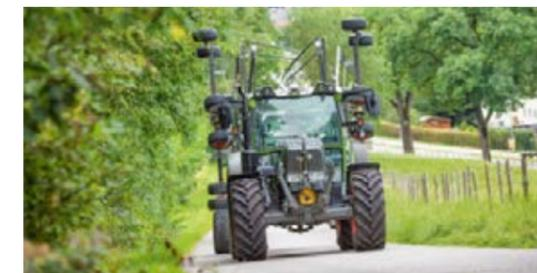
Su tratti pianeggianti il trattore si sposta a velocità ridotta. Giunto alla salita, il sistema TMS aumenta i giri del motore e adatta il rapporto di trasmissione. Appena viene ridotta la richiesta di potenza di trazione, il sistema TMS riduce il regime del motore per la massima economia possibile.
