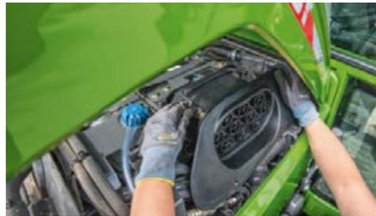
Il filtro aria con prefiltro a ciclone garantisce le massime prestazioni nella portata aria e nella durata del filtro. È compatto, leggero e sigillato particolarmente bene. Vantaggio: bassa manutenzione.
