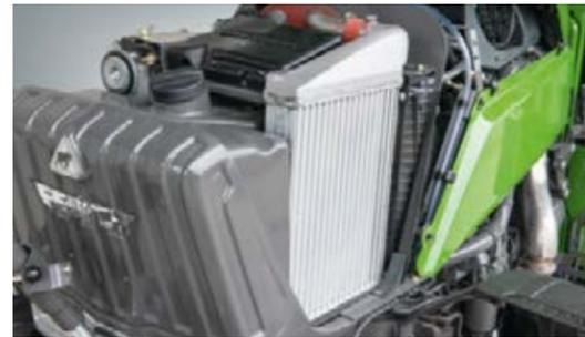
L'impianto di raffreddamento a forma di U presenta grandi aree di aspirazione con un'alimentazione ottimale dell'aria. Vantaggio: basso livello di contaminazione in condizioni estreme. Il radiatore olio del cambio raffredda l'olio idraulico con uno scambiatore di calore.
