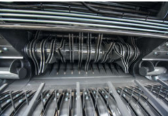
Rotore XtraCut13 (Distanza coppia di dita: 90 mm) - Senza unità di taglio (di serie) - Con unità di taglio: fino a 13 coltelli
