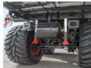
A richiesta tutti i modelli possono essere dotati di sterzo idraulico o elettronico a comando forzato. Il design intelligente ed efficiente permette inoltre un angolo di sterzata di 60° anche con sterzo a comando forzato.
