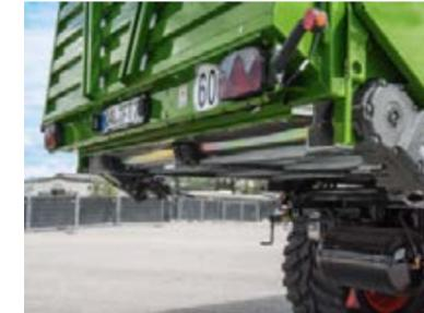
Il fondo ribassato in acciaio zincato garantisce una perfetta protezione anticorrosione durante il trasporto dell'insilato di mais.
