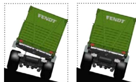
Senza il sistema di controllo automatico del livellamento, il veicolo si inclina in discesa o di lato in pendenza a seconda del carico e della velocità di svolta (vedi figura a sinistra). Con il controllo automatico del livellamento FSC invece il veicolo è sempre parallelo al pendio. Il veicolo si adatta sempre all'altezza ottimale del telaio in funzione del carico (vedi figura a destra).
