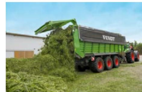
Tutti i carri della serie Tigo PR e XR possono essere dotati di 2 o 3 rulli di scarico. Per un volume di carico ancora maggiore, i singoli rulli possono essere semplicemente spinti verso il posteriore.
