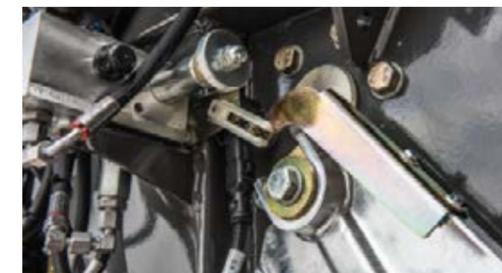
Il controllo della posizione del timone garantisce che l'angolo di apertura impostato del pickup sia mantenuto e controllato automaticamente. Questo garantisce un flusso di prodotto uniforme e costante senza costrizioni e un rastrellamento pulito anche in terreni collinari.
