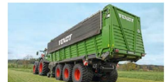
La copertura del cassone è idraulica e di facile attivazione mediante il terminale.
