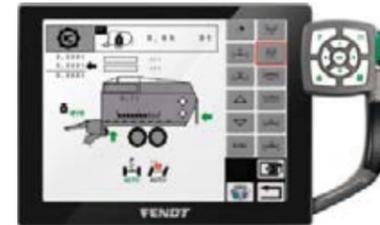
Controllate la paratia frontale e la piattaforma di taglio tramite il vostro terminale. Da qui è possibile regolare in modo agevole anche il pickup e il timone.
