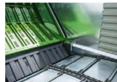
Per proteggere il rotore dalla corrosione e dallo sporco durante la raccolta dell'insilato di mais, il Fendt Tigo è dotato di una copertura del canale di alimentazione, che può essere montata rapidamente senza attrezzi.
