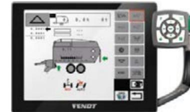
Con TIM ready, il Tigo XR può regolare la velocità del trattore in funzione della densità dell'andana e della capacità del pickup.
