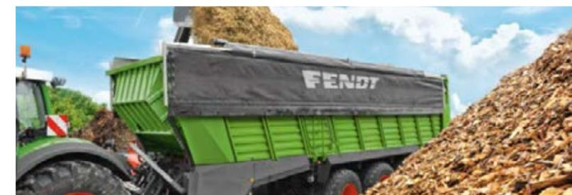
Il design del Fendt Tigo senza telaio tubolare consente di riempirlo facilmente dall'alto, indipendentemente dal fatto che si usi la pala o la trincia.
