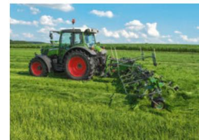
È possibile ottenere risultati perfetti anche lungo il bordo del campo grazie ad un dispositivo di spandimento ai bordi.
