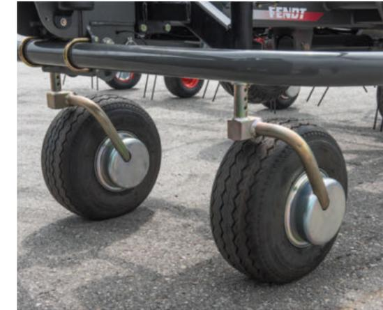
□ Le ruote tastatrici girevoli come optional assicurano l'adattamento al terreno e una raccolta pulita con buona protezione del manto erboso. (Fendt Twister 901 T)
