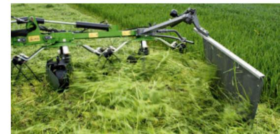
Nel Twister 11010 DN, modello top di gamma, lo spandimento ai bordi viene effettuato mediante un apposito telo a richiesta, ripiegabile idraulicamente.
