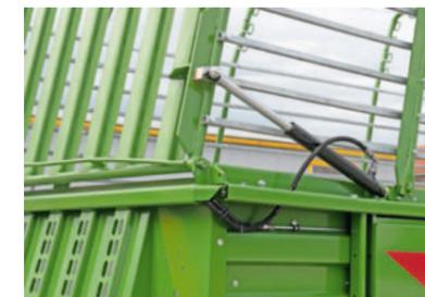
Un'altra opzione è rappresentata dalla sovrastruttura ripiegabile idraulicamente.
