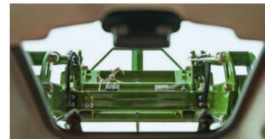
Il 200 Vario è dotato di un finestrino sul tetto di serie, per avere la visibilità migliore durante i lavori di caricamento anteriore. È possibile aprire il finestrino verso l'esterno per aumentare la ventilazione all'interno della cabina. Una tendina parasole integrata protegge dalla luce solare intensa.
