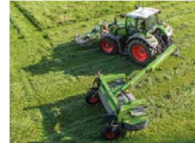
La barra falciante della Fendt Slicer TKC e TRC è sollevata dai punti esterni del robusto telaio di supporto, ciò garantisce un adattamento perfetto al suolo.
