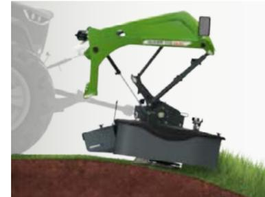
Se la barra si solleva, si inclina automaticamente fino a 15°. Questo mantiene l'altezza di taglio costante e assicura una protezione totale del manto erboso.
