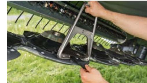
I dischetti DriveGuard, di facile sostituzione, sono gli strumenti perfetti per proteggere la trasmissione angolare compatta.
