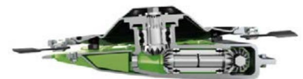
La trasmissione angolare compatta assicura una potenza in uscita uniforme a tutti i dischi di taglio e di conseguenza un taglio netto, che richiede potenza ridotta.
