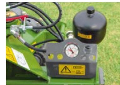
La compensazione idropneumatica TurboLift consente una flottazione ottimale durante il taglio.
