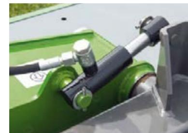
Il cilindro di compensazione stabilizza l'unità di falciatura a fine campo e su strada.
