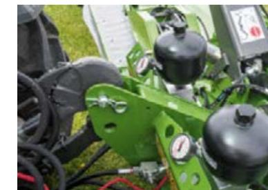
Il manometro di campo fornisce una panoramica della perfetta pressione di contatto del sistema TurboLift e ne consente la regolazione anche dalla cabina.
