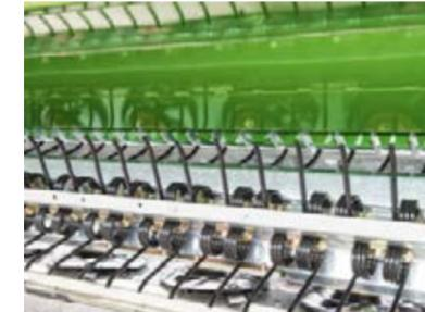
Tutti i condizionatori sono azionati direttamente tramite un albero nella scatola del cambio di ingresso o tramite una trasmissione implementata.
