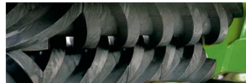
Il condizionatore a rulli RC assicura un condizionamento delicato senza perdita di foglie. Gli elementi in gomma possono essere sostituiti singolarmente se usurati o danneggiati.
