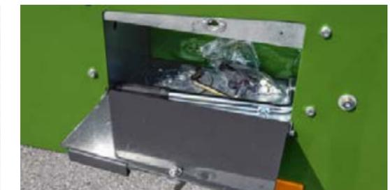
Nella barra di traino della Fendt Slicer 3575 T è stata integrata una cassetta degli attrezzi per lavori di manutenzione veloci.
