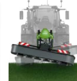
Anche la libertà di movimento è enorme con la Fendt Slicer FQ: con un angolo di oscillazione trasversale di +/-13° e una libertà di movimento verticale di 650 mm, la FQ è un vero talento di mobilità.
