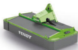
Falciatrici frontali con telaio oscillante Alpin Sviluppate appositamente per l'impiego alpino Larghezza di lavoro 3,00 m
