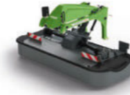
Falciatrici frontali con telaio a parallelogramma 3D
