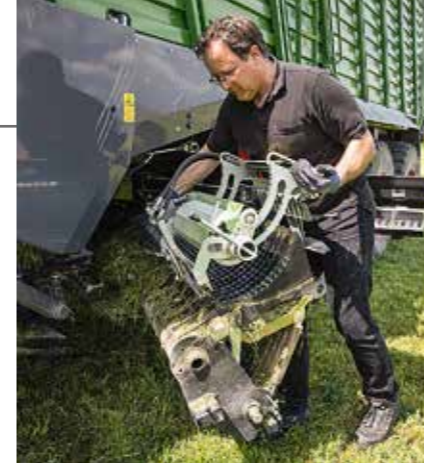
Il dispositivo di affilatura viaggia sempre assieme al carro e si applica per affilare dieci coltelli alla volta
