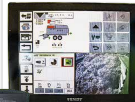
Il sistema TIM viene attivato dal terminale del Vario e funziona se è attivo il tempomat.
