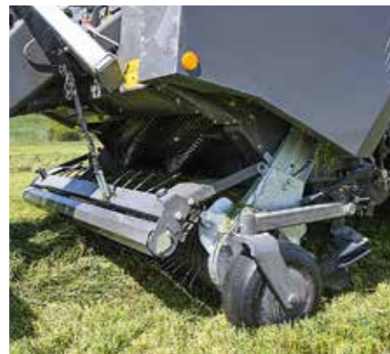
Il pickup è largo 2,20 m. Le ruote tastatrici laterali e un rullo posteriore si occupano dell'adattamento al terreno. Foto: Berning
