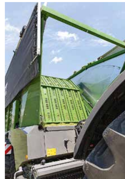
Un sensore di pressione nei cilindri della paratia frontale ribaltabile controlla il processo di caricamento e provvede alla precompressione.
