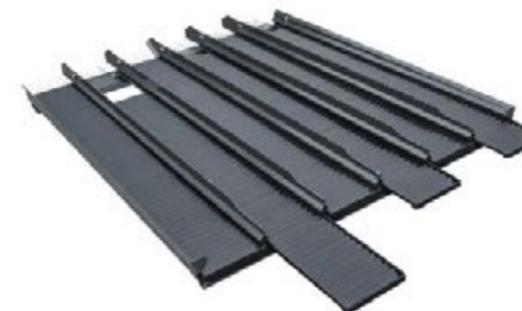
Qualora le condizioni di raccolta siano particolarmente umide, un piano preparatore pulito assicura un tasso di produttività elevato, nonché una qualità di trebbiatura ottimale. Per questa ragione il piano preparatore della Serie L Fendt è pratico e facile da rimuovere.
