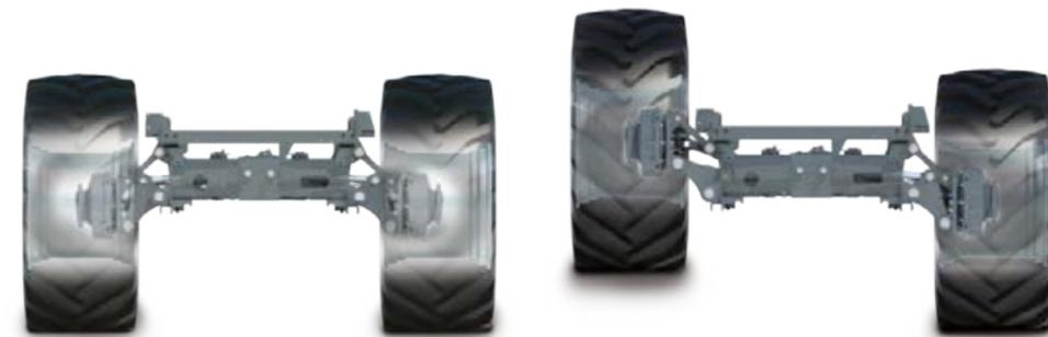
Facilità di passaggio tra modalità di lavoro e di trasporto mediante il sistema ParaLevel, che compensa dislivelli fino al 20%.
