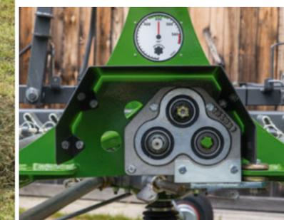
Trasmissione universale in metallo leggero fuso per il funzionamento frontale e posteriore.
