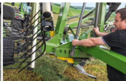
Comando semplice e requisiti ridotti sul il trattore in termini di regolazione della larghezza dell'andana del Former 12545.
