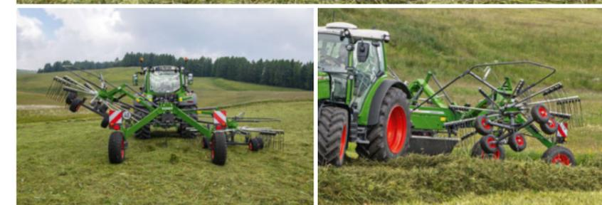
Il telaio andanatore si piega automaticamente verso l'alto una volta in capezzagna o in posizione di trasporto.
