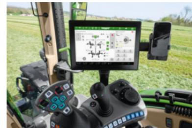
**ISOBUS UT:** le maschere di comando possono essere trasferite al terminale del trattore **ISOBUS AUX-N:** è possibile il trasferimento della leva di marcia
