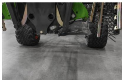
Il forma andana idraulico opzionale si piega automaticamente quando si sollevano i rotori e facilita l'attraversamento di andane alte e il trasporto su strade sterrate irregolari.
