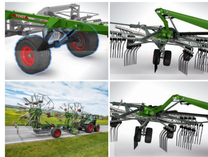
Anche gli pneumatici di grande volume dell'asse sospeso garantiscono una pressione al suolo ridotta.
