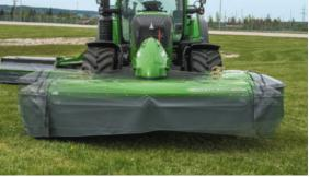
Con la possibilità di oscillare di +/- 5° il modello Fendt FPV può adattarsi al terreno, per catturare fino all'ultimo stelo d'erba.
