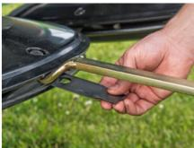
Il sistema di cambio rapido, provvisto di un pratico attrezzo speciale, rende il cambio delle lame un gioco da bambini.
