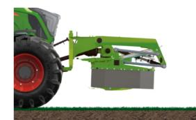
Le falciatrici a tamburo Fendt Cutter FZ con telaio ad alte prestazioni si adattano perfettamente al terreno con una corsa massima di 490 mm e sono delicate sul suolo grazie alla loro ampia superficie portante.
