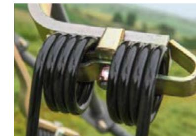
Tutti i denti "Super C" sono dotati di serie di un dispositivo di protezione contro la perdita, per proteggere le operazioni successive e gli animali.
