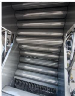
Tre scanalature dei rulli d'acciaio PowerGrip sono costantemente a contatto con la balla, garantendo una rotazione affidabile.
