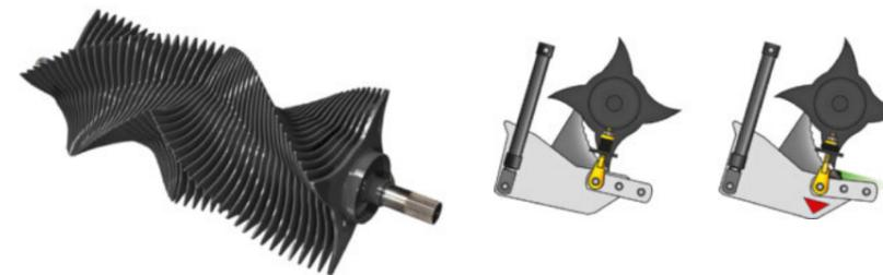
HydroflexControl previene in modo affidabile eventuali ingolfamenti. In caso di ingolfamento, la parte posteriore del piano di taglio si può abbassare di 500 mm.
