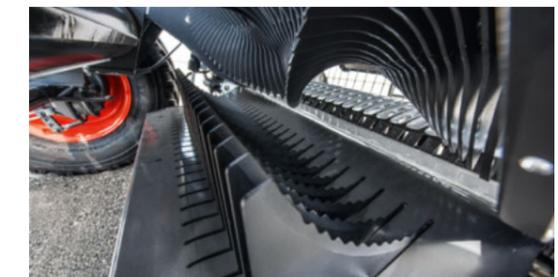
Il modello 130 F Xtra top di gamma si caratterizza per il gruppo di taglio idraulico comprendente 0, 12, 13 e 25 coltelli.
