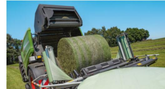
La giusta velocità per una fasciatura costante si ottiene grazie ad un azionamento attento dell'anello di fasciatura mediante rulli di gomma azionati idraulicamente.
