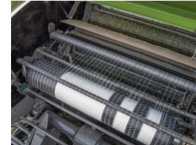
Le balle sono perfettamente legate anche attorno ai bordi grazie al dispositivo di spargimento rete. Questo dispositivo riduce al minimo le perdite e semplifica lo stoccaggio.
