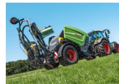
Fendt Rotana FC monta pneumatici 620/55 R 26.5 per un adattamento ottimale al terreno e una guida sicura su strada.
