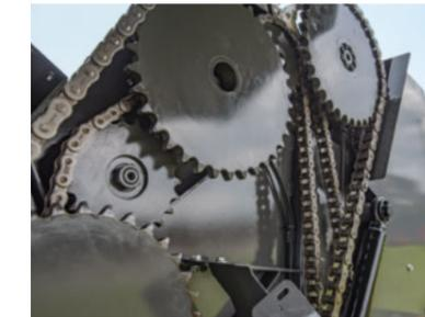
L'ingranaggio a ruota libera protegge la trasmissione da danni nel caso di ingolfamento del rotore.
