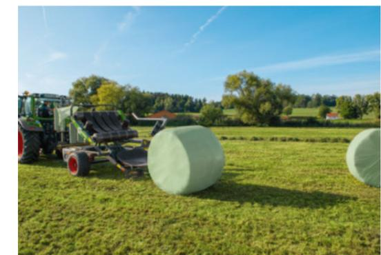
Sia il braccio di carico che il piano di fasciatura possono essere regolati in base alle dimensioni della balla. Le balle di diametro compreso tra 1,25 m e 1,6 m vengono sollevate in sicurezza e fasciate ermeticamente con la pellicola.
