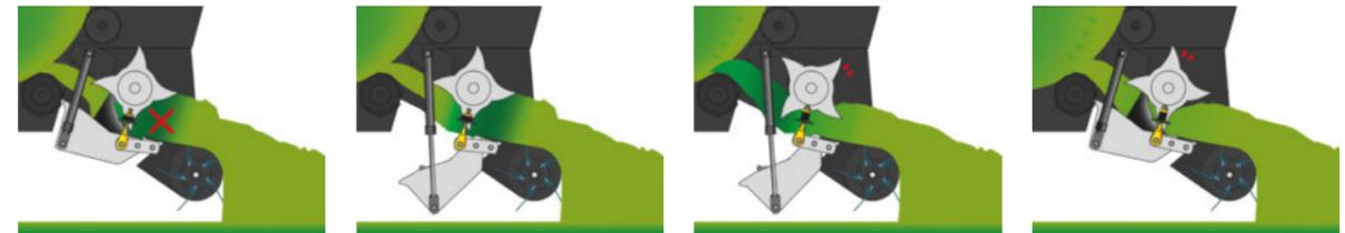
Nel caso di un blocco, la parte posteriore del piano di taglio si abbassa di 500 mm.
