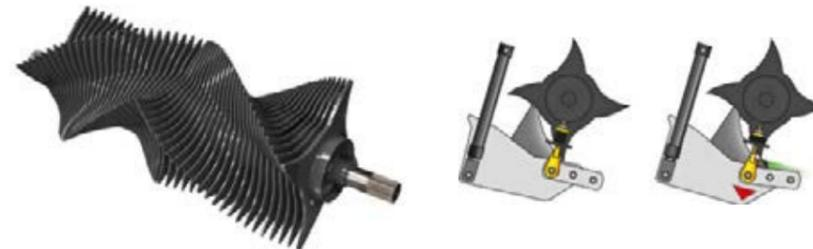
HydroflexControl previene in modo affidabile eventuali ingolfamenti. In caso di ingolfamento, la parte posteriore del piano di taglio si può abbassare di 500 mm.
