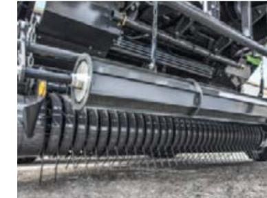
Grazie allo spazio ridotto tra il pickup e il rotore, il foraggio viene trasferito in modo sicuro e delicato. Grazie alla conformazione a V dei denti del rotore, la camera di pressatura viene riempita uniformemente per produrre poi balle perfette.
