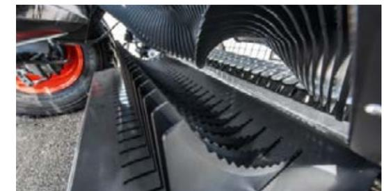
I modelli Rotana 160VXtra e 180VXtra sono in grado di innestare idraulicamente gruppi di taglio di 0, 12, 13 e 25 coltelli.
