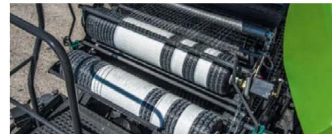
L'EasyLoadSystem permette di aggiungere rotoli di rete nel minor tempo possibile.
