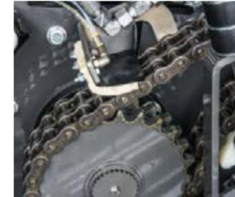
La trasmissione Power Split gira con velocità alla presa di forza di 540 giri/min.
