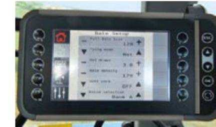
Grazie ad ISOBUS, la pressa comunica continuamente con i terminali ISOBUS integrati nel trattore, compreso il terminale Fendt Varioterminal.
