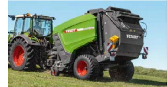
Le rotopresse Fendt a camera variabile facilitano la compressione delle balle fino ad un diametro compreso fra 0,70 e 1,60 m o 1,80 m.
