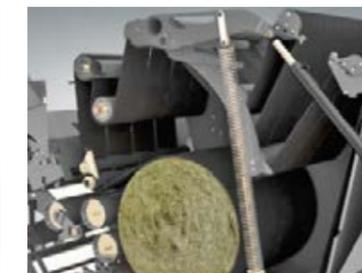
La trazione delle cinghie avviene mediante due rulli anteriori. Questo doppio avvolgimento dei rulli garantisce che la rotazione sia assolutamente sicura per qualsiasi tipo di balle.
