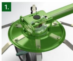
I fianchi dei denti temprati a induzione e molati garantiscono un funzionamento silenzioso e un'elevata resistenza alla rottura
