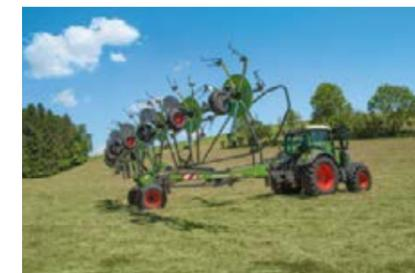
Nel trasporto su strada, i rotori sono posizionati sul telaio. Questo protegge i giunti rotanti che così non sono sottoposti a sollecitazioni in posizione chiusa. La posizione di trasporto particolare, con i rotori allineati, rende anche i modelli Lotus più grandi sufficientemente compatti per il trasporto.
