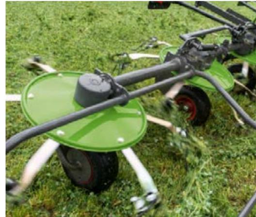
Pneumatici voluminosi su ogni rotore per una raccolta eccellente del foraggio e un adattamento al terreno ottimale.
