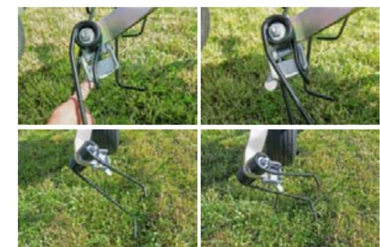
Una semplice regolazione dei denti sul rotore esterno attiva il meccanismo di spandimento lungo i bordi. I denti si portano così nella posizione più interna assicurando la pulizia del bordo del campo e la distribuzione ottimale del prodotto.
