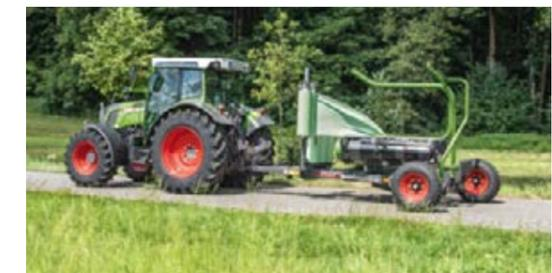
Fendt Rollector fascia balle di diametro compreso tra 0,90 m e 1,30 m.
