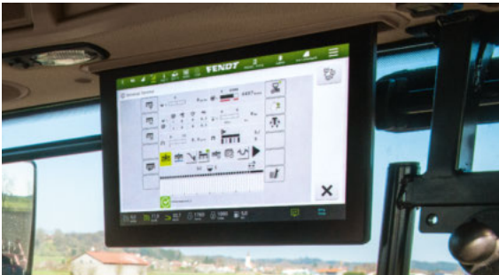
Non è necessario avere un terminale ISOBUS esterno Il terminale sul tetto da 12" aggiuntivo vi offre perfino più spazio di visualizzazione. Potete mostrare i dati dell'attrezzo ISOBUS sul terminale del tetto, ad esempio, mentre il terminale sul braccio mostra la guida automatica. I terminali esterni non sono più necessari.
