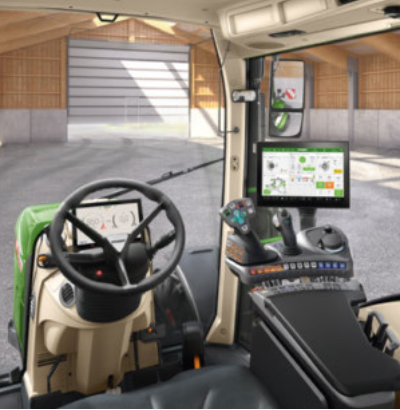
Profi+ Setting 2 - Joystick 3L - 1 modulo lineare (coppia a bilanciere) per controllare le valvole idrauliche - Terminale da 12"
