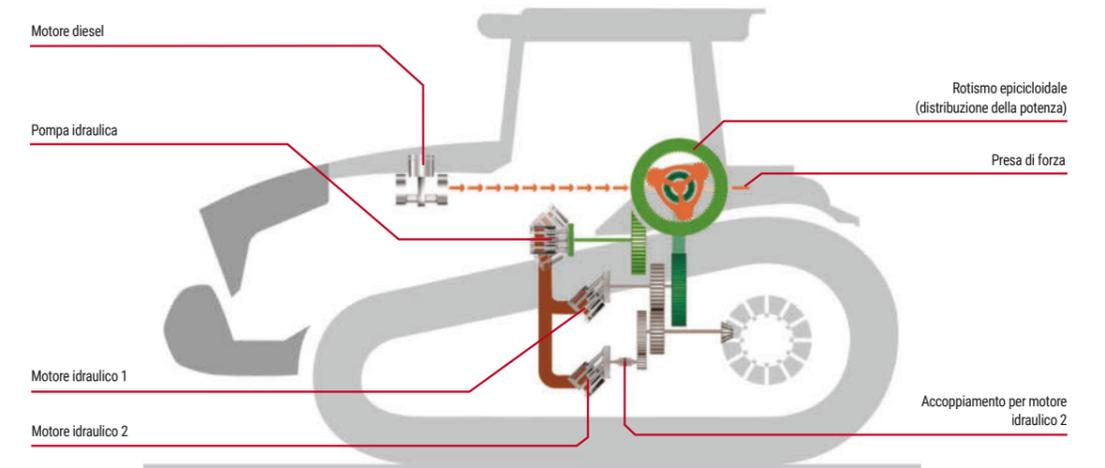
Schema della trasmissione del Fendt VarioDrive
