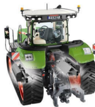
1.345 kg: 32 zavorre all'interno e all'esterno del telaio cingolo (16x per cingolo); deflettore antidetriti all'interno
