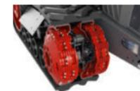
1.588 kg: 28 zavorre ruote tendicingolo (7x per ruota tendicingolo)
