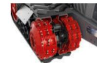
2.041 kg: 36 zavorre ruote tendicingolo (9x per ruota tendicingolo)
