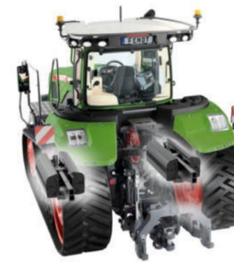
2.690 kg: 64 zavorre all'interno e all'esterno del telaio cingolo (32x per cingolo)
