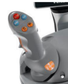
Utilizzando il joystick (di serie), è possibile controllare la velocità, i cruise control, la velocità motore e la gestione capezzagna.
