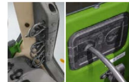
Fendt offre una soluzione intelligente per i cavi che dalla parte posteriore o anteriore del trattore passano in cabina. Attraverso i passaggi speciali possono passare cavi di qualsiasi dimensione. Il lunotto può rimanere chiuso, in modo da non far entrare polvere, sporco, acqua e rumore.
