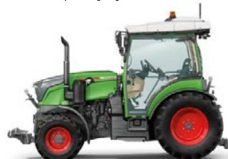
Il serbatoio diesel da 68 litri o 83 litri (a richiesta) nel montante A consente lunghe percorrenze e semplicità di rifornimento. In aggiunta, è presente un serbatoio da 16 litri di AdBlue posto nella parte anteriore del cofano. Lavora a lungo senza dover fare rifornimento.
