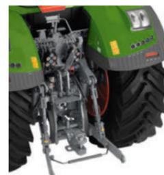
Sollevatore posteriore con estremità sferiche e blocchi di sfregamento
