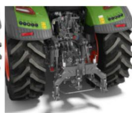
Telaio Quick Hitch con apertura idraulica di serie dei sollevatori
