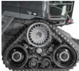
„TrakRide“ vikšrinė pavara sudaro galimybes dirbti mažai suplūkiant grunto paviršių.
