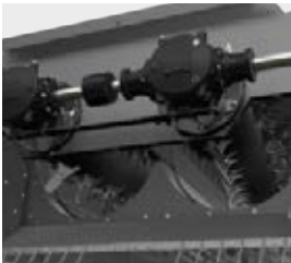
Dėl galimybės hidraulinio būdu pasukti rotorius atgal iš kabinos, kamščius galima lengvai ir idealiai išvalyti.
