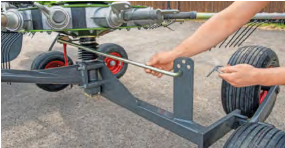
Nesvarbu, ar pašarai yra ilgi ir sunkūs, ar trumpi ir lengvi: kumštelių darbinį paviršių galima paprastai sureguliuoti taip, kad jis atitiktų derliaus nuėmimo sąlygas.
