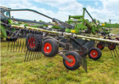
Nuleidžiant galulaukėse, galiniai ratai žemę pasiekia pirmiau, ir tik tada nuleidžiami priekiniai ratai. Pakeliant, rotoriai pirmiau pakeliami priekyje. „Jet-Effect“ funkcija apsaugo nupjautą plotą.
