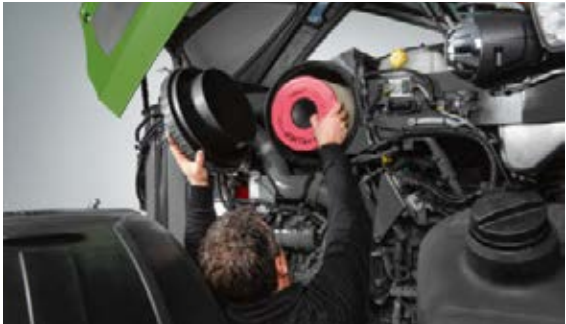
Nešvarumų kiekis oro filtruose yra rodomas per „Varioterminal“. Variklio skyrius yra lengvai pasiekiamas nuėmus šoninius variklio skydelius.
