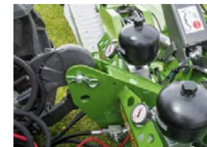
Bet kada galima įvertinti „TurboLift“ sistemos kontaktinį slėgį tiesiog pažvelgus į darbo lauke manometrą ir reguliuoti jį nepakylant nuo patogios sėdynės.
