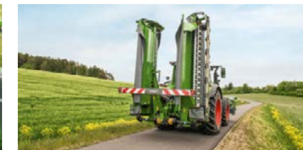
Suskleista žoliapjovė neviršija 4 m aukščio ir ją paprasta pervežti dėl žemo sunkio centro.
