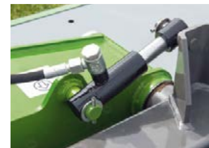
Kompensavimo cilindras stabilizuoja žoliapjovės agregatą galulaukėje ir važiuojant keliu.
