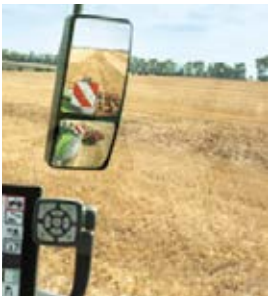
Platleņķa spoguļus var brīvi pārvietot, un tie paplašina redzamības leņķi uz aizmuguri.
