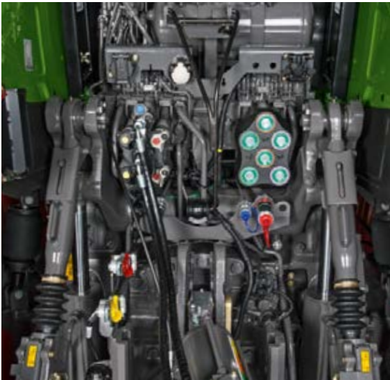
Fendt 1000 Vario var pielāgot, pievienojot vai noņemot kādus elementus. Pilnīgi aprīkotā aizmugurējā zonā ir visi savienojumi un funkcijas, piemēram, "Power beyond", ISOBUS kontaktligzda, aizmugurējā atgrieze, jūgvārpsta un aizmugurējais uzkares mehānisms.
