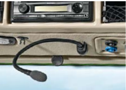
Fendt 1000 Vario jūs varat izmantot tālruni brīvroku režīmā vislabākajā kvalitātē: ar elastīgo izlocīto mikrofonu abas rokas ir brīvas un akustika ir perfekta.
