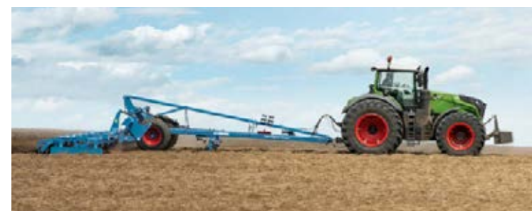
Pateicoties TMS traktora pārvaldības sistēmai un automātiskajai maksimālās jaudas kontrolei 2.0, traktors optimāli pielāgo dzinēja apgriezienus braukšanas ātrumam.
