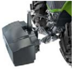
Priekšējais uzkares mehānisms ir pilnīgi iebūvēts traktorā.
