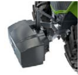
Izmantojot luksusa balasta satvērēju, priekšējos atsvarus var paņemt ātri un viegli, pat bez priekšējās uzkares.
