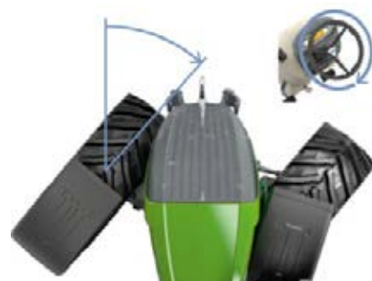
Ar VarioActive jūs iegūstat pilnu pagriezienu leņķi līdz ar vienu stūres pagriezienu.
