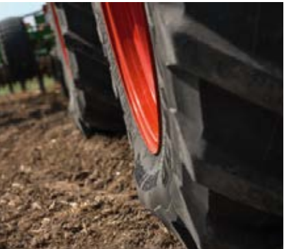
Ideālā integrētā riepu spiediena regulēšanas sistēma VarioGrip dažu minūšu laikā spēj izmainīt spiedienu riepās no 0,6 līdz 2,5 bāriem. Ar optimālu spiedienu riepās tiek ietaupīta degviela, aizsargāta augsne un palielināta vilce.
