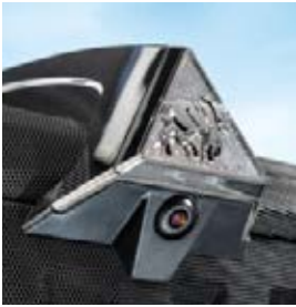
Praktisks priekšā piemontētiem agregātiem: jaunā kamera, kas iebūvēta pārsegā, uzņem skatu uz uzkares rokām un pārraida attēlu uz termināli Varioterminal.
