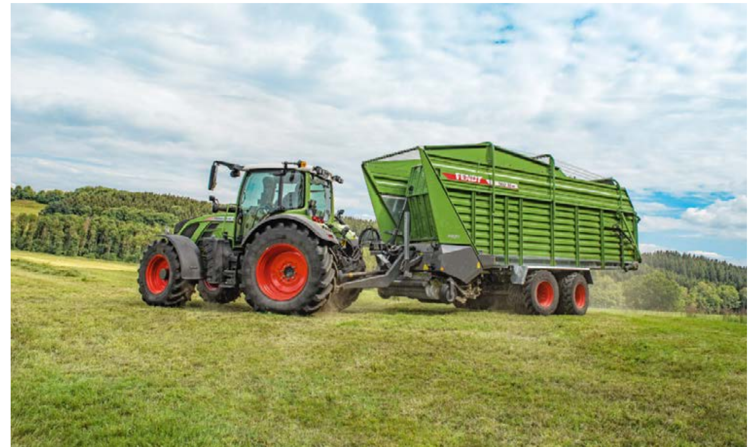
Sinhronizētais perifēriskais ātrums ļauj masas pacelējam ar mazu ātrumu apiet rotora izvirzījumu.
