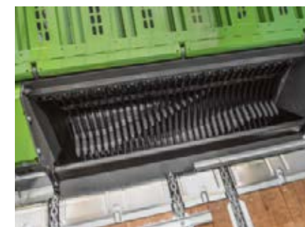
Rotors ar 800 mm diametru un sešām spirālveida zobu rindām ir izgatavots no Hardox tērauda un abās pusēs aprikots ar lieliem lodveida rullīšu guļņiem.
