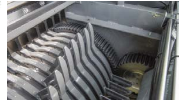
Galvenā pievada enerģiju no pievada ķēdes uz rotoru vada īpaši spēcīgi cilindriski zobratu ar cieši saspiestu sazobi.
