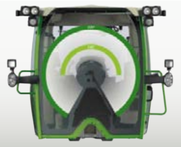
Pilna redzamība ar 300° stikla tīrītāja lauku: īpašais vējstikla tīrītājs nosedz visu redzes lauku, līdz pat riteņu arkām.
