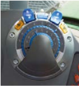
Intuitīva darbība ar kompakto uzkares celšanas mehānismu (EPC) un jūgvārpstas kontroli.
