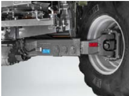
□ AllDrive: een as van de vierwielaandrijving
