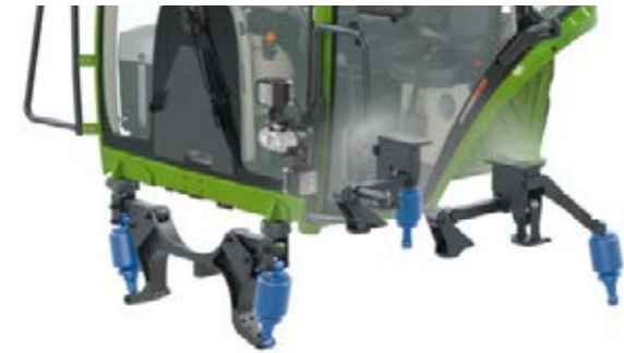
De op vier punten aangebrachte pneumatische comfort-cabinevering met geïntegreerde niveauregeling, vermindert trillingen tot een minimum.
