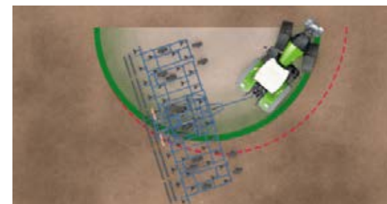
Kleine draairadius door het 'pull-in turn'-effect, bijv. 6,97 meter bij de Fendt 1038 Vario op standaardbanden.
