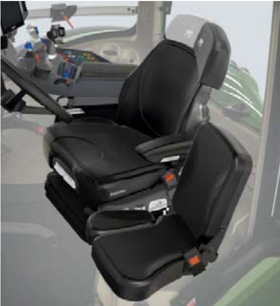
De DualMotion-comfortstoel Fendt Evolution Active is voorzien van actieve vering en van zeer hoogwaardige en vuilafstotende zwartleren bekleding. Ook de bijbehorende comfort-bijrijdersstoel is in leer uitgevoerd.
