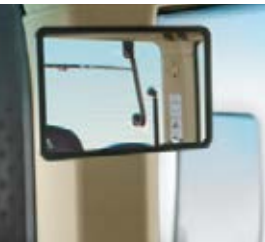
Via de binnenspiegel hebt u steeds zicht op de aangekoppelde werktuigen.
