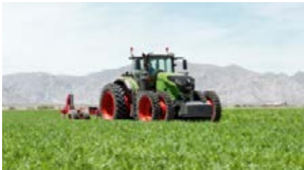
Ten behoeve van normen buiten Europa kan de achterzijde ook van zgn. rub blocks en een quick-hitch-frame worden voorzien. Indien gewenst kan de Fendt 1000 Vario op een spoorbreedte van 60 inch (1,5 meter) worden gezet.
