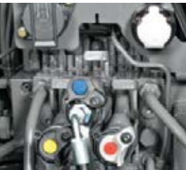
Via de DODK-koppelingen kunnen alle hydrauliekventielen aan beide zijden onder druk worden aan- en afgekoppeld. Dankzij de drukontlastingshendels is (ont) koppeling gemakkelijk mogelijk.
