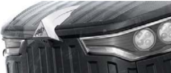
Led-dagrijlicht en werklampen zijn geïntegreerd in de voorzijde van de motorkap. Ook is een motorkapcamera aanwezig.
