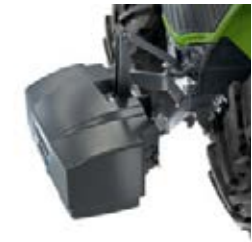
Met behulp van de comfort-ballastopname kunnen frontgewichten ook zonder frontheef snel en gemakkelijk worden aangebracht.
