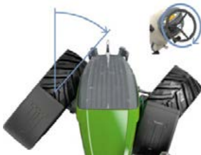
Met VarioActive leidt één keer ronddraaien van het stuur al tot een volledige stuuruitslag.
