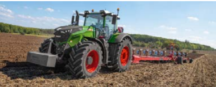
Met behulp van het Trekker Management Systeem (TMS) en de automatische grenslastregeling 2.0 past de trekker het motortoerental automatisch aan de rijsnelheid aan.
