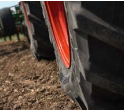
Het perfect geïntegreerde VarioGrip-bandendrukregelsysteem regelt binnen enkele minuten de bandenspanning tussen 0,6 en 2,5 bar. De optimale bandenspanning leidt tot brandstofbesparing, het ontzien van de bodem en betere tractie.
