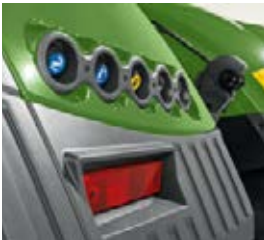
Met de externe ventielbediening worden vanaf de achterspatborden de achterheef, één hydrauliekventiel en de aftakas rechtstreeks bediend.
