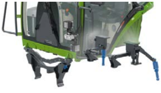
De mechanische cabinevering rust voor op twee conische lagers en achter op twee mechanische veerelementen.
