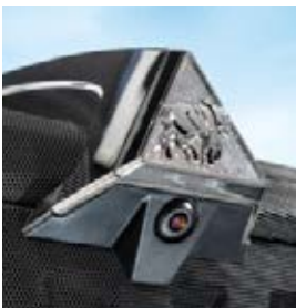
Praktisch bij frontwerktuigen: de in de motorkap geïntegreerde camera is gericht op de trekstangen van de fronthef en zendt de beelden door naar de Varioterminal.
