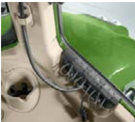
De geïntegreerde kabeldoorvoer maakt bij een gesloten achterrait schone doorvoer van kabels mogelijk, beschermd tegen vuil, water en geluid. Dus geen woud aan kabels in de cabine: alle kabels zijn netjes aan de kabeldoorvoeren aan de C-stijl bevestigd.
