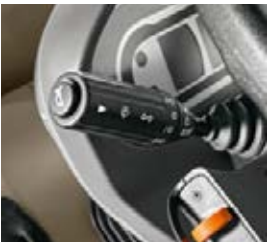
Net als bij iedere andere Fendt maakt de Fendt 1000 Vario de dagelijkse werkzaamheden een stuk aangenamer door praktische details, zoals het automatische terugspringen van de richtingaanwijzer: het licht blijft knipperen tot het einde van de bocht en schakelt dan automatisch uit.
