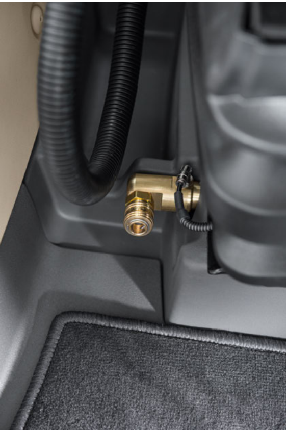
De cabine is snel schoon te maken: de bestuurdersstoel (super-comfortstoel Evolution) is voorzien van een praktische aansluiting voor een perslucht slang, waarmee de cabine kan worden gereinigd.
