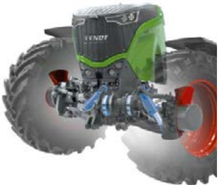
Vooras met per wiel een remsysteem en niveaugeregelde vering
