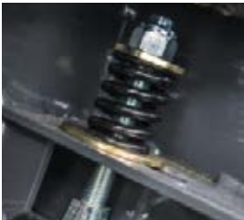
De Flexcontrol-veer vangt de piekbelastingen van het voorste deel van de invoerbodem op en voorkomt zo dat verstoppingen ontstaan.
