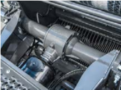
De Powersplit-tandwielkast werkt met een toerental van 540 t/min.
