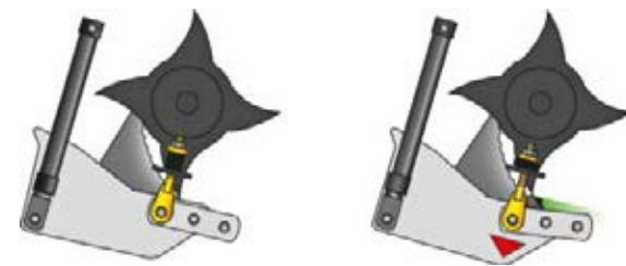
Het FlexControl-veersysteem weet verstoppingen effectief te voorkomen.
