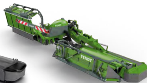
Maaicombinaties met ISOBUS Volledige automatisering met transportband Werkbreedte 9,30 m
