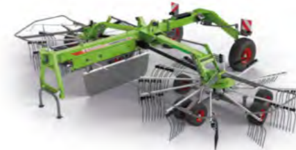
I-weerrotorhark met middenafleg en transportonderstel
