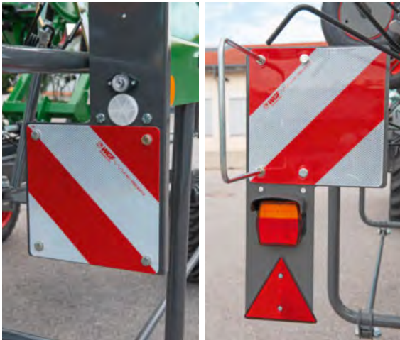
Ter vergroting van de veiligheid in het wegverkeer zijn de getrokken Lotus-modellen standaard voorzien van grote waarschuwborden en een verlichtingsbalk.
