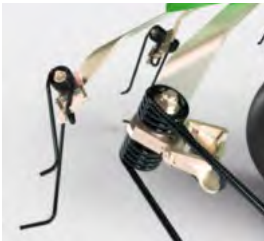
De korte afstand tussen wiel en tanden zorgt ervoor dat de machine zich steeds uitstekend aan de bodem aanpast.
