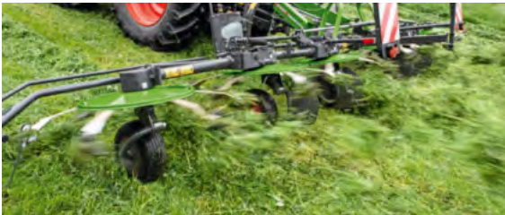
Het antiwikkelsysteem voorkomt dat zich gewas rond de wielassen wikkelt.
