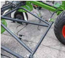
Ten behoeve van de stabiliteit beschikken de getrokken schudders over een hulframe, dat de machine over de volledige breedte zowel stijver maakt als beschermt.
