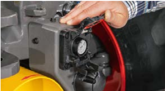
ISOBUS-aansluitingen De Fendt 700 Vario is zowel aan achter- als voorkant van een ISOBUS-contactdoos voorzien.
