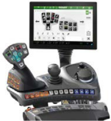
Power, Setting 2 - Kruishendel - Geen wipschakelaar-paar (lineaire module) om de hydrauliekventielen te bedienen
