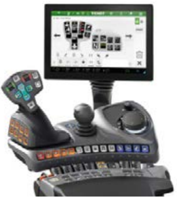
Profi Setting 1 en Profi+ Setting 1 - Kruishendel - 2 paar wipschakelaars (lineaire modules) om de hydrauliekventielen te bedienen
